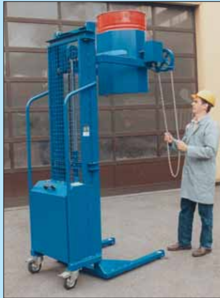
Fahr- und lenkbar und elektrohydraulischem Hub, Fass-Schwenkvorrichtung manuell zu betätigen.
