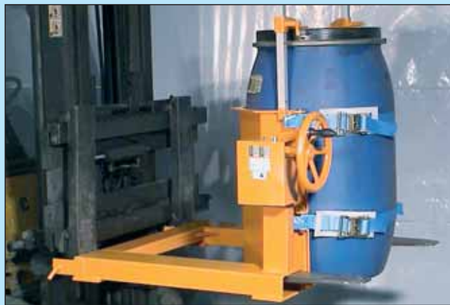
Ausführung für Stahl- und Kunststoff-Fässer
