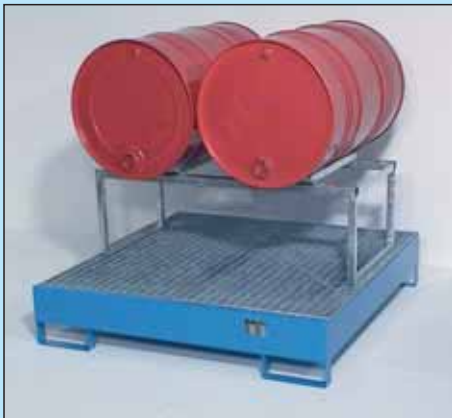
Auffangwanne mit Einlege-Gitterrost u. Standfüßen Ausführung mit Fassbock für 2 liegende Fässer LxBxH = 1300x1300x660 mm (gesamt) Inh. 209 l
